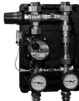
Regumax sa skladá z trojcestného zmiešavacieho ventilu, obehového čerpadla, uzatváracieho ventilu, teplomerov a izolácie. Výhoda tohto riešenia spočíva v kompaktnosti, jednoduchosti obsluhy a zaručenej ochrane tepelného výmenníka kotla.
